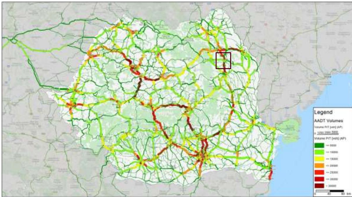
Segmentele modelate sunt caracterizate de parametri geometrici și tehnici, precum: denumire, lungime segment, stare tehnică, numărul de benzi de circulație, felul circulației (unidirecțională / bidirecțională), capacitate de circulație, viteza maximă legală, rang, moduri de transport permise și alte atrbute stabilite de către utilizator.
