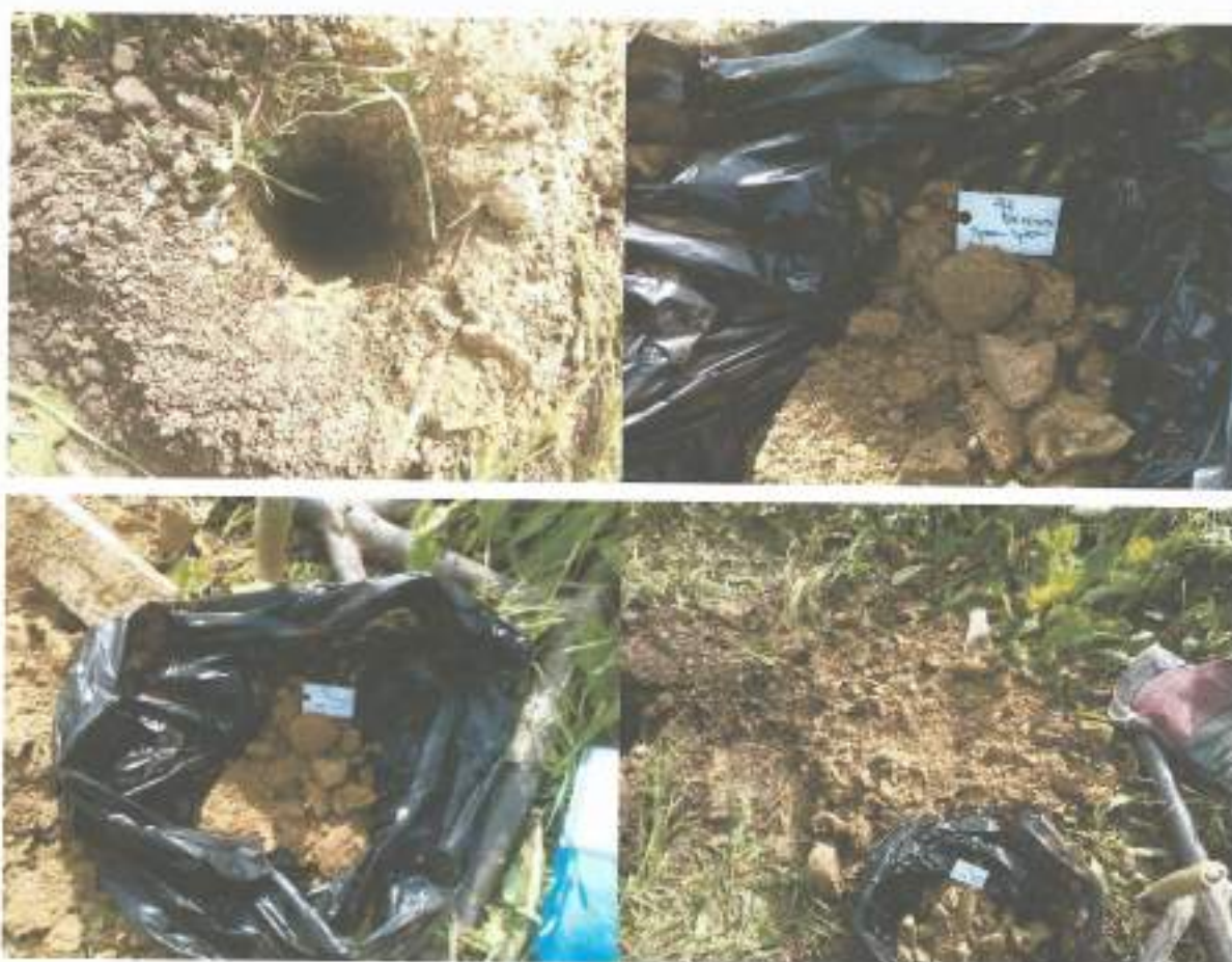
Fig. 10 Foraj geotehnic și prelevare probe de pământ
